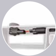
Sensoren mit Plug&Play wieder anschließen
